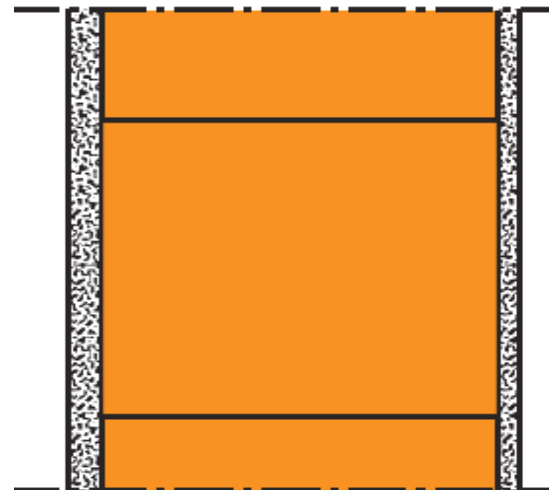
Abb. 5.4-1: Einschalige Außenwand mit beidseitigem Putz, aus [1].
