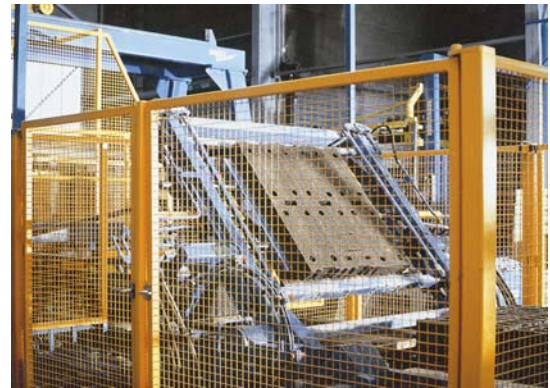
Abb. 4.2.5-3: Steine werden verarbeitungsgerecht gedreht.
