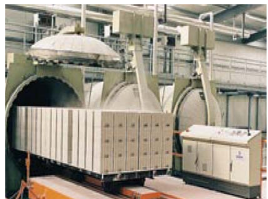
Abb. 4.2.3-5: Das Härten der Rohlinge erfolgt in Autoklaven. Bild: Masa-Dorstener
