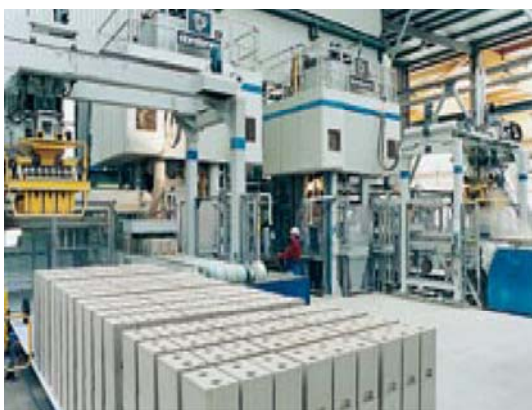
Abb. 4.2.3-4: Nach dem Mischen erfolgt das Pressen der Rohlinge. Bild: Masa-Dorstener
