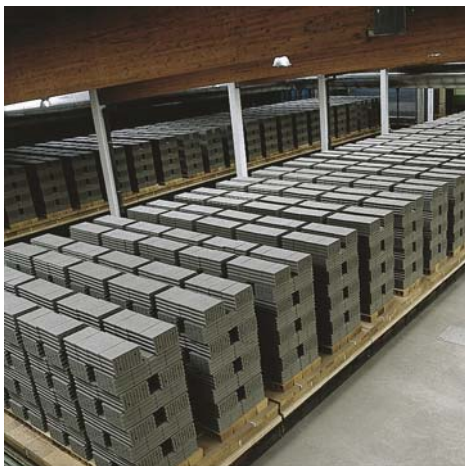
Abb. 4.2.2-6: Getrocknete Ziegel auf Tunnelofenwagen.
