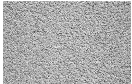
Abb. 4.1.3-4: Oberfläche eines als Kratzputz ausgeführten mineralischen Edelputzes (Foto: Saint-Gobain Weber GmbH).
